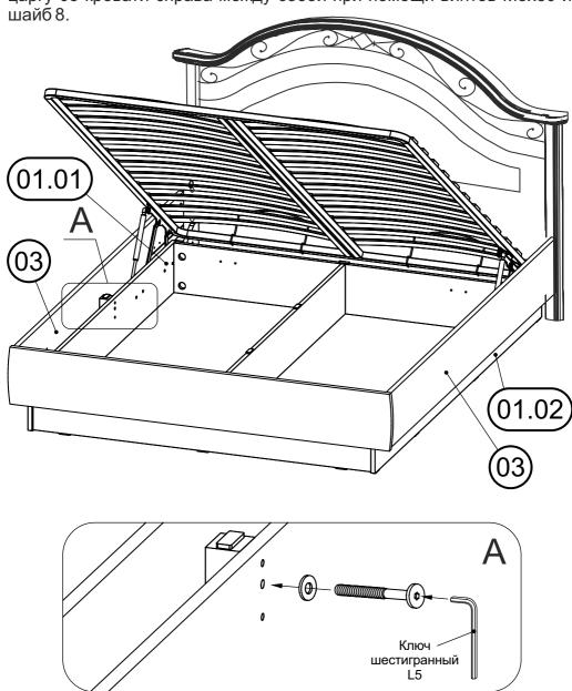
5. Закрепить поперечную царгу 14 основания и ножную царгу 02 кровати или спинку кровати между собой при помощи четырех саморезов 4х40 с прессшайбой.
