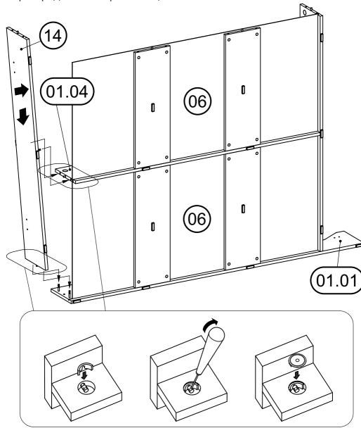
Порядок сборки сегментных стяжек: в отверстия перегородки 04 и поперечной царги 03 вставить сегменты и с помощью шила завернуть винты до упора. В отверстия вставить заглушки.
