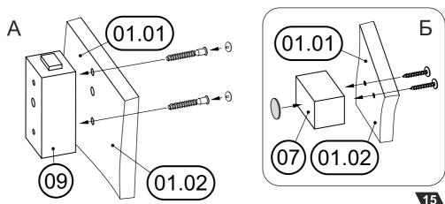
Установить кронштейны подъемного механизма без газовых лифтов на продольные царги правую 01 и левую 02 и наживить при помощи гаек со сферической головкой и винтов М6х20 Под головки винтов М6х20 подложить увеличенные шайбы 6. Обратить внимание, что гайка должна располагаться внутри ниши.
