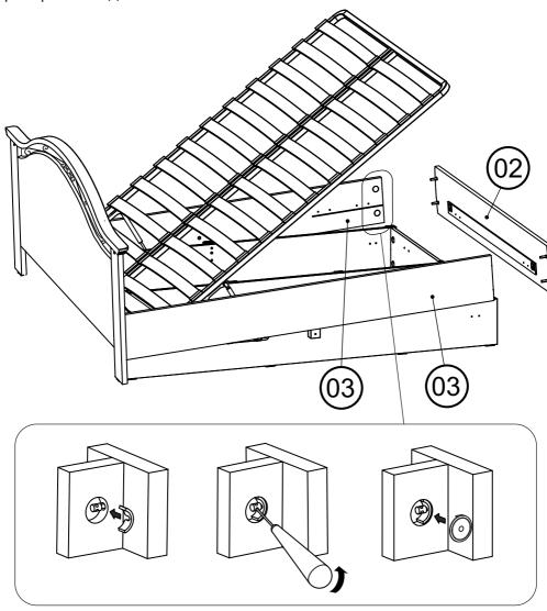
Порядок сборки сегментных стяжек: в отверстия боковых царг 03 вставить сегменты и с помощью шила завернуть винты до упора. В отверстия вставить заглушки.
