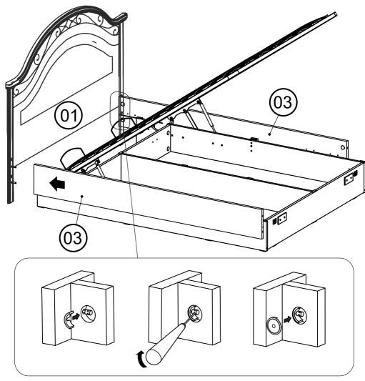
Порядок сборки сегментных стяжек: в отверстия боковых царг 03 вставить сегменты и с помощью шила завернуть винты до упора. В отверстия вставить заглушки.
