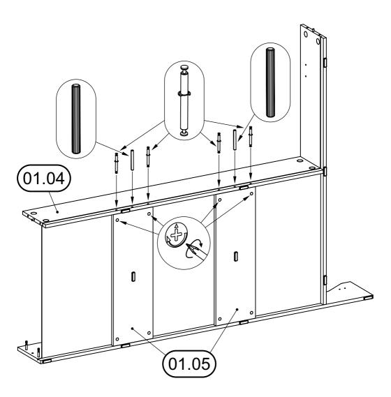
Присоединить ребра жесткости 01.05 к перегородке 01.04, совместив двусторонние штоки и шканты с отверстиями сопрягаемых деталей.
