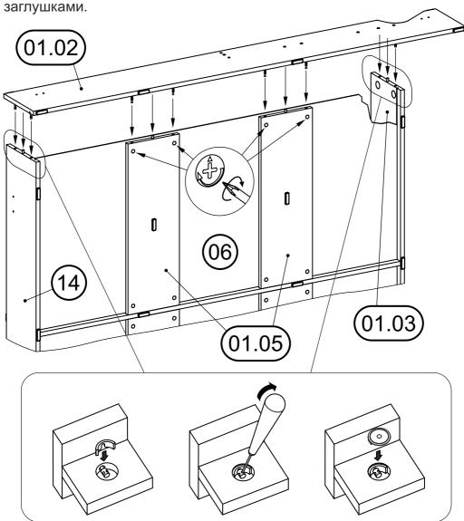
Порядок сборки сегментных стяжек: в отверстия поперечных царг 03 вставить сегменты и с помощью шила завернуть винты до упора. В отверстия вставить заглушки.
