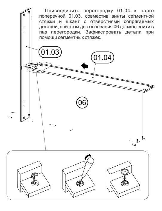
В сквозные отверстия у нижней кромки перегородки 01.04 установить два шканта 8x60 и четыре двусторонних штока длинной частью до эксцентриков ребер жесткости 01.05.
