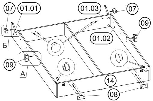
Снять защитную пленку с двусторонней клеящей ленты на накладках 08. Наклеить накладки 08 на царгу поперечную 14, совместив отверстия на соединяемых деталях. На поперечной царге 01.03, на продольных царгах 01.01 и 01.02 неиспользуемые отверстия изнутри основания закрыть заглушками  $\emptyset$ 5 мм.
