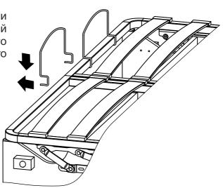
Поднять ортопедическое основание и установить газовые лифты **цилиндром вверх** на сферические опоры левого и правого кронштейнов подъемного механизма до щелчка.
