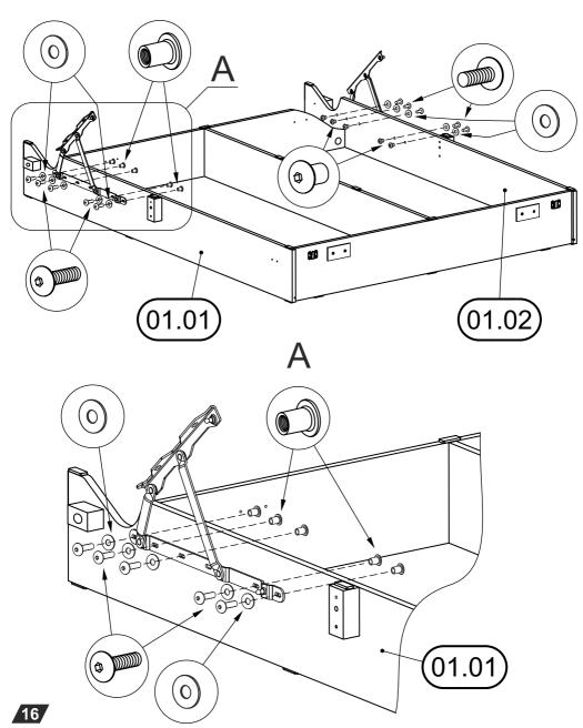
На кронштейны подъемного механизма установить и наживить при помощи болтов М8х45, гаек самостопрящихся М8 и шайб металлических. Опустить ортопедическое основание на каркас и выровнять основание относительно продольных и поперечных царг каркаса так, чтобы край основания и поперечная царга были в одной плоскости. Затянуть гайки при помощи ключей на 13 до упора.
