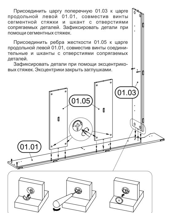
Порядок сборки сегментных стяжек: в отверстия царги 03 вставить сегменты и с помощью шила завернуть винты до упора. В отверстия вставить заглушки.
